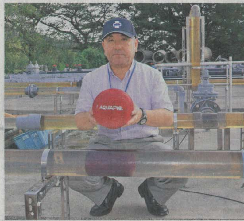
洗浄具のアクアピグを手にする中里社長と、管 内を低速で通過中の同洗浄具（手前）＝27日午 後、佐野市
