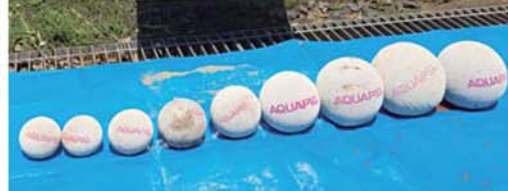
洗管を終えたアクアピグ。口径30〜500mmまでラインナップ
